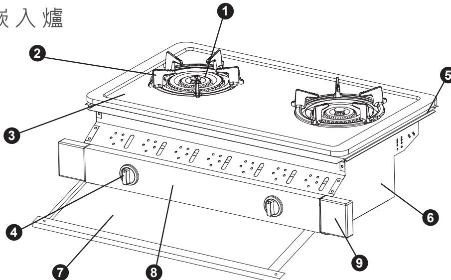
1 爐頭 2 爐架 3 面板 4 開關鈕 5 防水膠條 6 本體 7 清潔拉板
